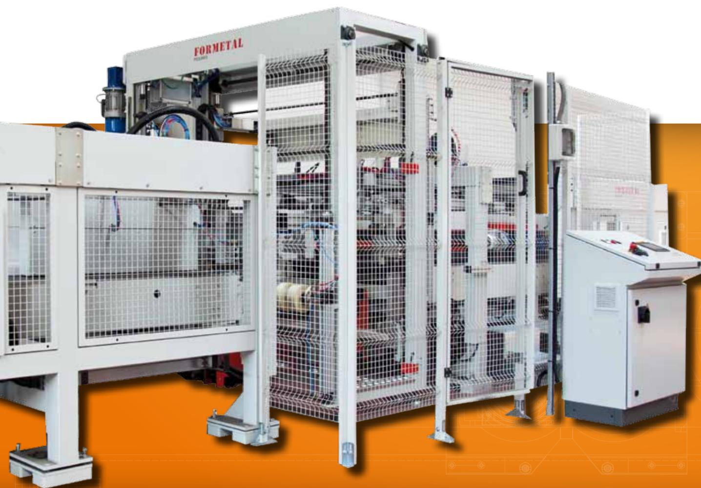
Impianto automatico per la chiusura di scatole in cartone contenenti pannelli o parti di mobili smontati in kit, l'impianto utilizza preformati in cartone di opportune dimensioni, con lavorazioni adeguate alla formazione della confezione da eseguire. L'impianto è autodimensionante, riconosce cioè la dimensione del collo in lavorazione preposizionando in automatico i vari gruppi di trascinamento, pressione e nastratura.
