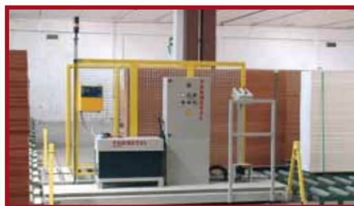
Navetta automatica a doppia pista per posizionamento pile in magazzino linee di carico. Double track automatic shuttle for the positioning of stacks in the loading line warehouse. Navette automatique à double piste pour positionnement piles dans entrepôt lignes de chargement. Navecilla automática con doble pista para posicionamiento pilas en almacén líneas de carga.
