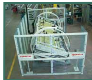
Ribaltatore a botte per pannelli. "Barrel" type panel dumping machine. Basculeur « à tonneau » pour panneaux. Volteador de cuba para tableros.
