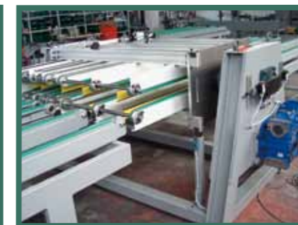
Ribaltatore longitudinale per pannelli. Longitudinal panel dumping machine. Basculeur longitudinal pour panneaux. Volteador longitudinal para tableros.
