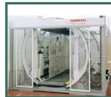
Ribaltatore a botte per pile. "Barrel" type stack dumping machine. Basculeur « à tonneau » pour piles. Volteador de cuba para pilas.
